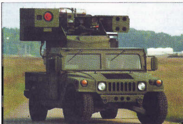
Тактический комплекс лазерного оружия на базе ЗРК ближнего действия «Авенджер» (демонстрационный образец)
